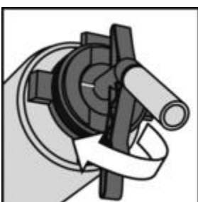
AA210 Spray Nozzle een kwartslag draaien.
